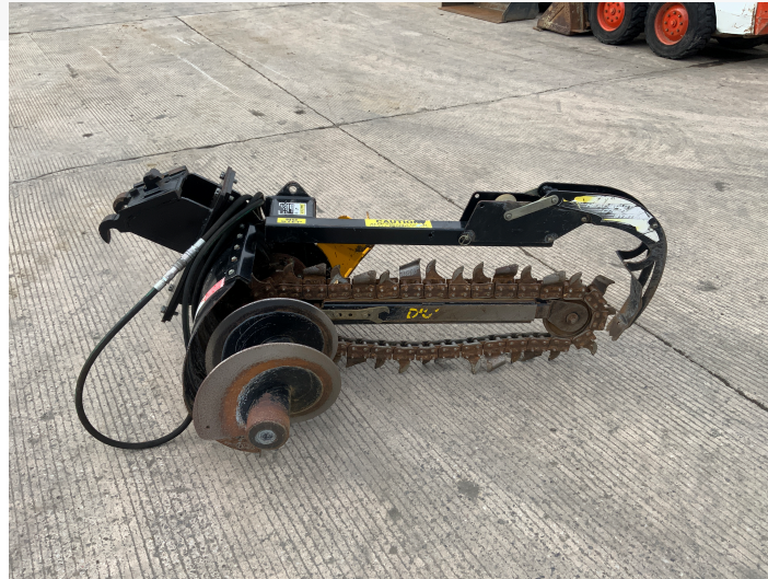
DIGGA BFT 00013 TRENCHER
