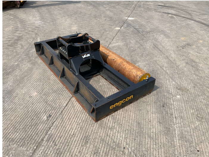
ENGCON 6,7 GRADER BAR C/W ROLLER
